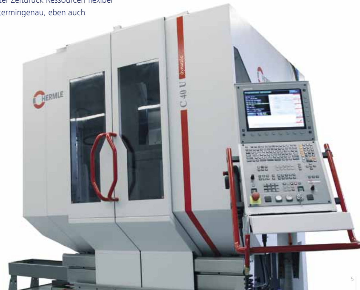
Fräsbearbeitungszentrum mit 5 Achsen am Standort Triberg
