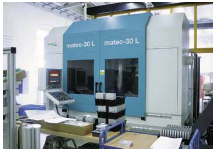
Fräsbearbeitungszentrum für Bauteile bis 2000 mm am Standort in Genthin
